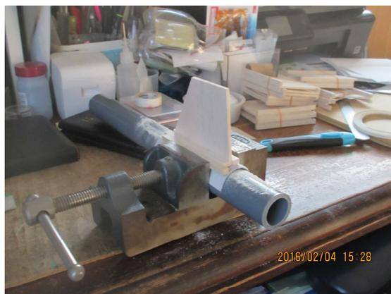
③スカートの中に3カ所に等分に線を引いた紙を入れてセロテープで留め、接着する場所の目標にする。尾翼の下面に接着剤（セメダインスーパー X2）を塗り、付属のへらでならして、すぐに接着場所（紙の線の上）に接着し、洗濯ばさみで4箇所を押さえてこのまま1日おく。
